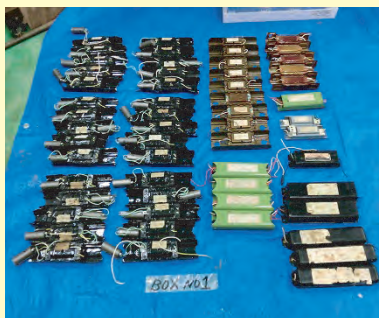
安定器のPCB含有調査作業
